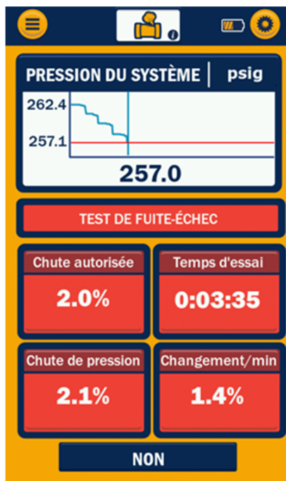
Figure 24: Test de décroissance de la pression - ÉCHEC
