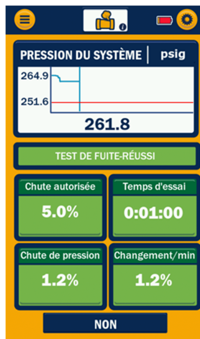
Figure 25: Test de décroissance de la pression - RÉUSSITE
